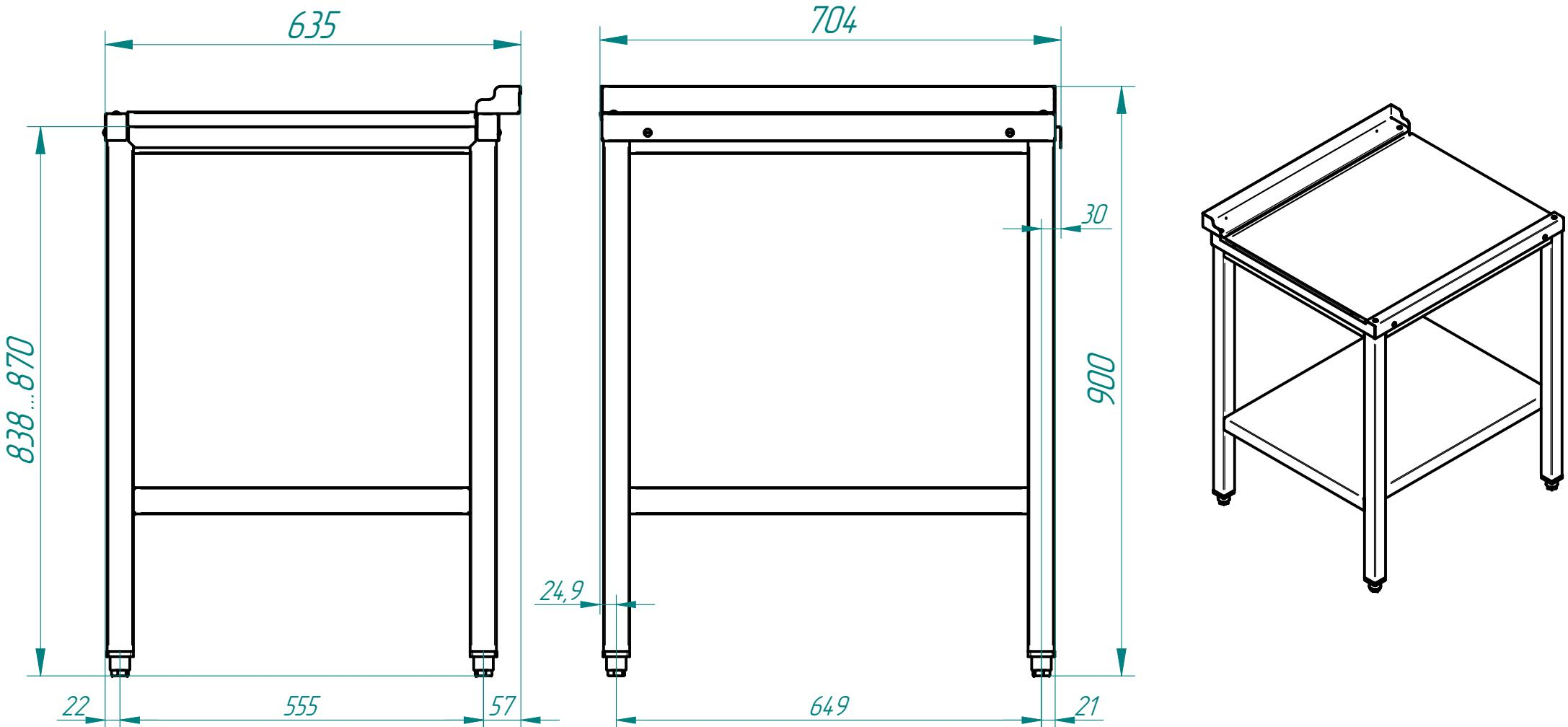
Стол раздаточный СПМР-6-2 используется в комплексе с посудомоечной машиной, имеет полку, регулируемые по высоте ножки (не менее 20 мм). Стол полностью разборный с обвязкой по четырем сторонам, изготовлен из высококачественной нержавеющей стали. Путем несложного монтажа стол можно установить как в правом, так и в левом исполнении.
